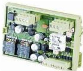
Модуль получает сигналы активации системы пожаротушения от панелей ХС10 и управляет батареей с огнетушащим составом. Кроме того, он контролирует потерю огнетушащего вещества.
