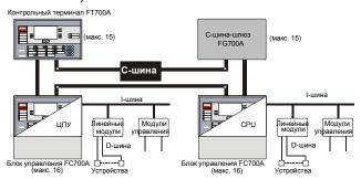
FC700A – модулярная 4-16 контурная панель управления пожарной сигнализацией для использования с аналоговыми адресуемыми устройствами Synova<sup>TM</sup>. FC700A может быть самостоятельной или работать в сети с до 16 панелей, пользовательских терминалов или шлюзов BMS.
