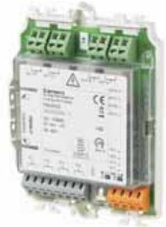
Для VdS-соответствия устройства активации пожаротушения. Четыре устройства ввода для «сухих» контактов. Осуществляется мониторинг входящей линии для проверки наличия разрывов и короткого замыкания (оконечные резисторы). Устройства ввода могут быть независимо сконфигурированы с помощью станции управления обнаружением пожара для сообщений о состоянии или о тревоге.
