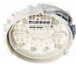
База изготовлена из ударопрочного и устойчивого к царапинам пластика и других экологически безопасных материалов. Встроенная резиновая прокладка обеспечивает защиту от протечек, грязи и попадания капель воды сверху. Клеммы без винтов для упрощения монтажа. Предусмотрено место для дополнительных клемм, таких как микроклеммы 0,5 мм<sup>2</sup> или соединительные клеммы 2,5 мм<sup>2</sup>. Подходит для всех скрытых монтажных коробок от 55 до 80 мм.
