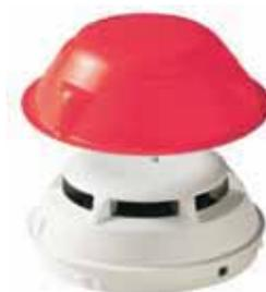
Для обнаружения возгораний с выделением дыма, а также тлеющего огня. Работа устройства основана на принципе рассеянного света с применением оптического сенсора прямого рассеяния. Различные комбинации параметров настройки обеспечивают выбор режима срабатывания извещателя. Базу необходимо заказывать отдельно.
