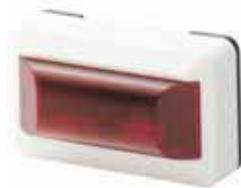
Индикатор тревоги AI91C представляет собой визуальный индикатор, подключающийся параллельно с пожарными извещателями, используемыми на линии извещателей SynoLINE300. Он оснащен темно-красным светящимся элементом на светодиодах. Тревожный индикатор идеально подходит для использования в тех местах, где пожарный извещатель трудно увидеть (например, в номерах гостиниц, распределительных щитах). Индикатор AI91C может использоваться в дверных проемах.
