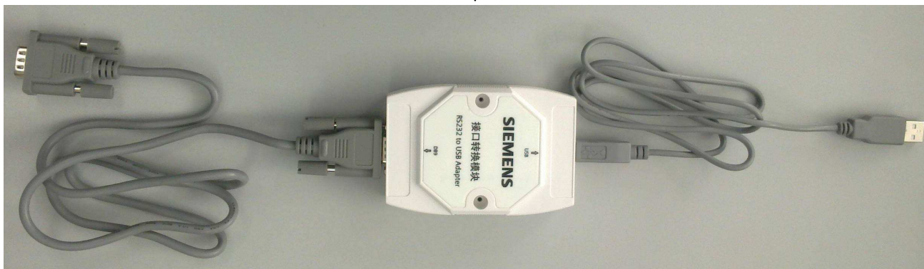
Рис. 1 Подключение кабелей к адаптеру
